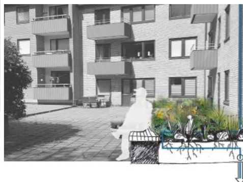
Figur 32: Nedan visas en principskiss över en upphöjd regnbädd på innergård framtagen av Ramböll.
