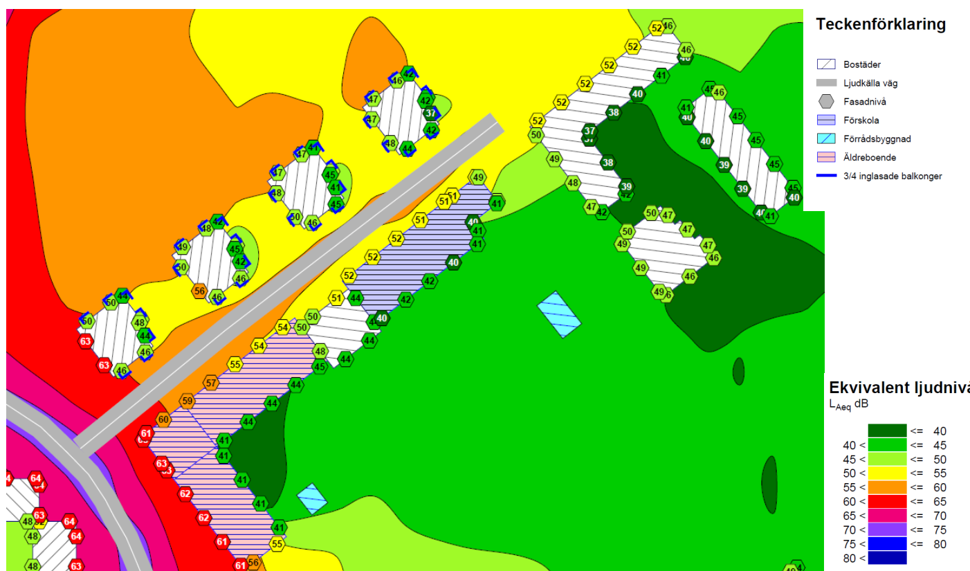
Figur 28. Bullerberäkningar för ekvivalenta ljudnivåer år 2040. I beräkningarna har punkthusen försett med balkonger som är inglasade till 75%. Akustikverkstan 2021-01-12
