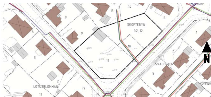
Distributionsledningar för vatten (blå linjer), avlopp/spill (röda linjer) och dagvatten (gröna linjer)
