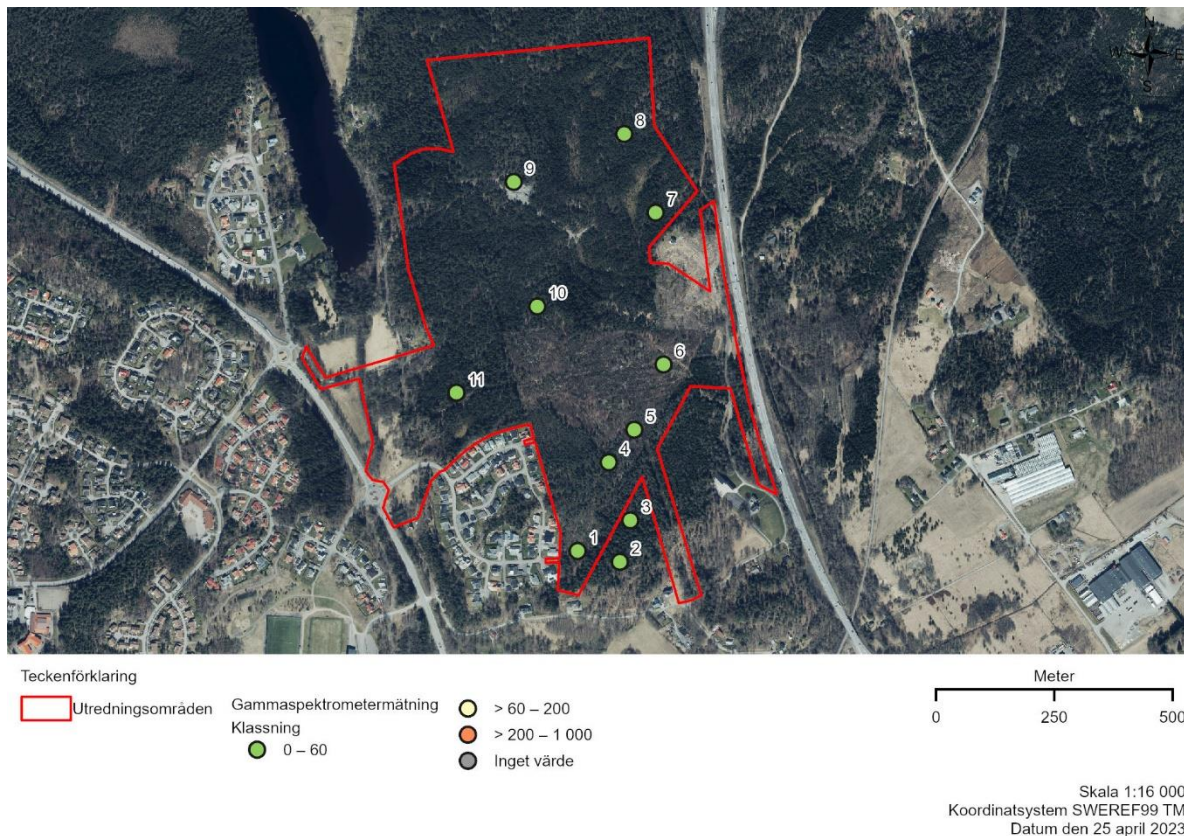
Figur 6 De elva mätpunkternas lokalisering i och utanför området markerade med gröna, gula och röda cirklar beroende på radiumaktiviteten (Bq/kg).
