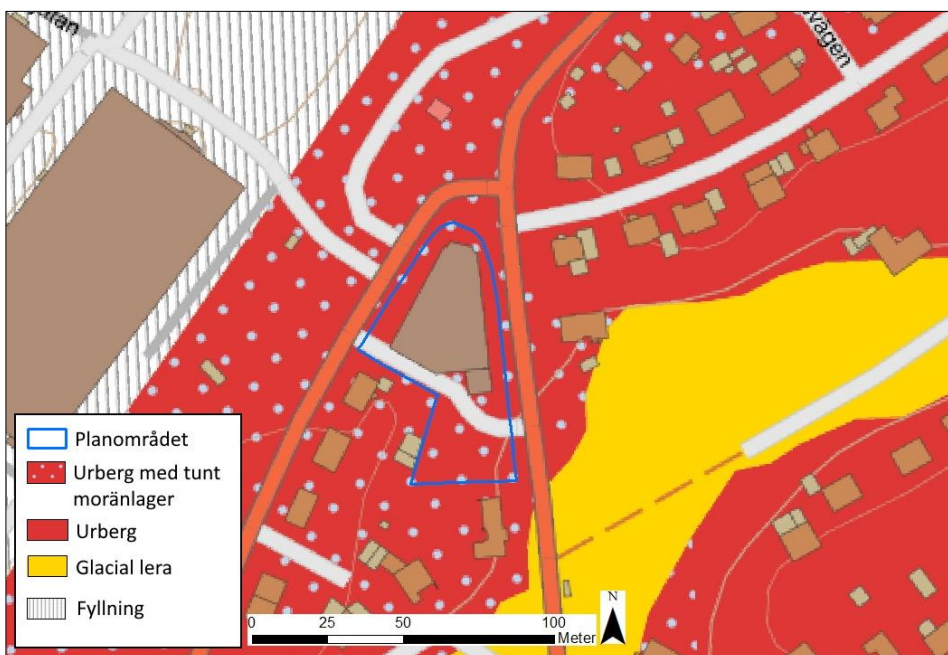
Figur 2. Jordartskarta från Sveriges Geologiska Undersökning (SGU) som visar att planområdet består av urberg med tunt moränlager. Kartan är hämtad från SGU:s visningstjänst för jordarter 1:25 000–1:100 000
